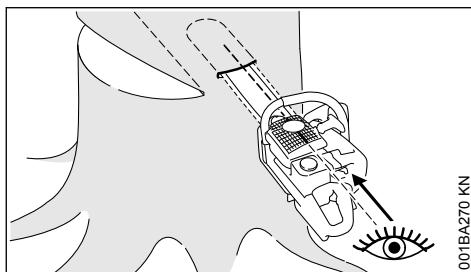
Se possibile, usare l'asta d'incisione. L'asta d'incisione e la pista superiore e inferiore della spranga sono parallele.
