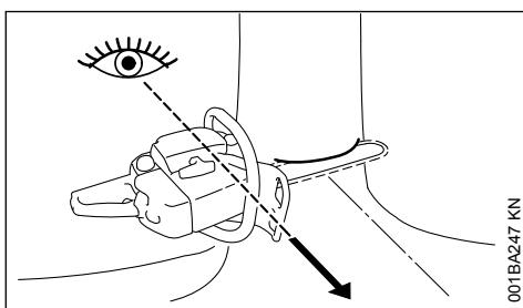
En exécutant l'entaille d'abattage, orienter la tronçonneuse de telle sorte que l'entaille d'abattage forme un angle droit par rapport à la direction de chute.
